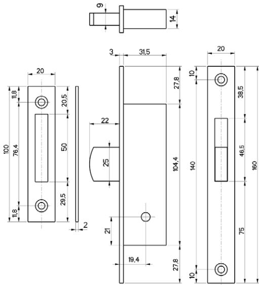
Serratura da infilare per montanti. Interasse 20.
