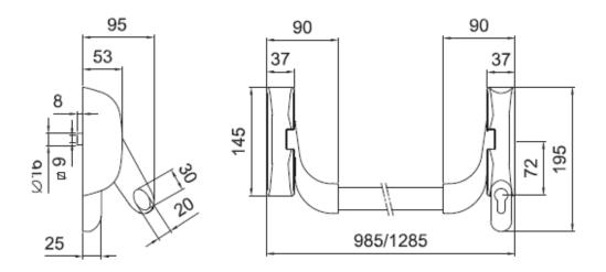
Maniglione antipanico "IDEA Base" CHIUSURA LATERALE, reversibile, verniciato NERO. Scrocco In zama senza autobloccante. Incontro 94100110. Spessore in nylon per comando esterno. Dima. Istruzioni di montaggio.
