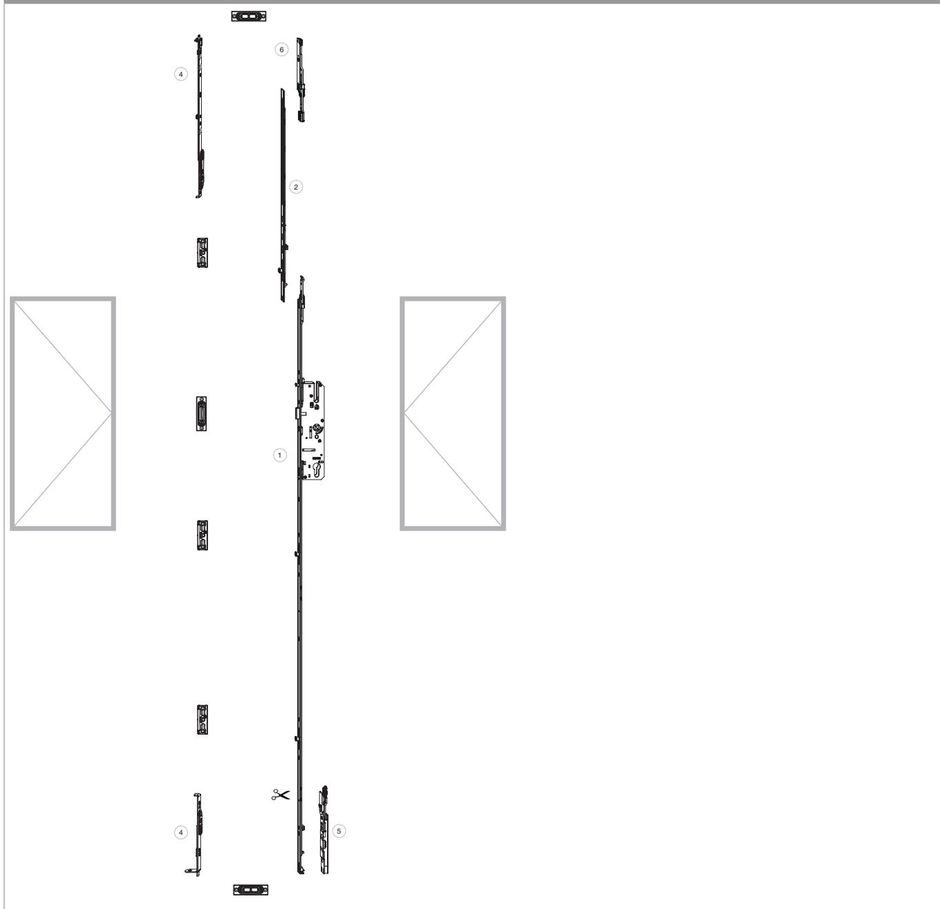
203829 - Serratura per portafinestra con scrocco con 2
