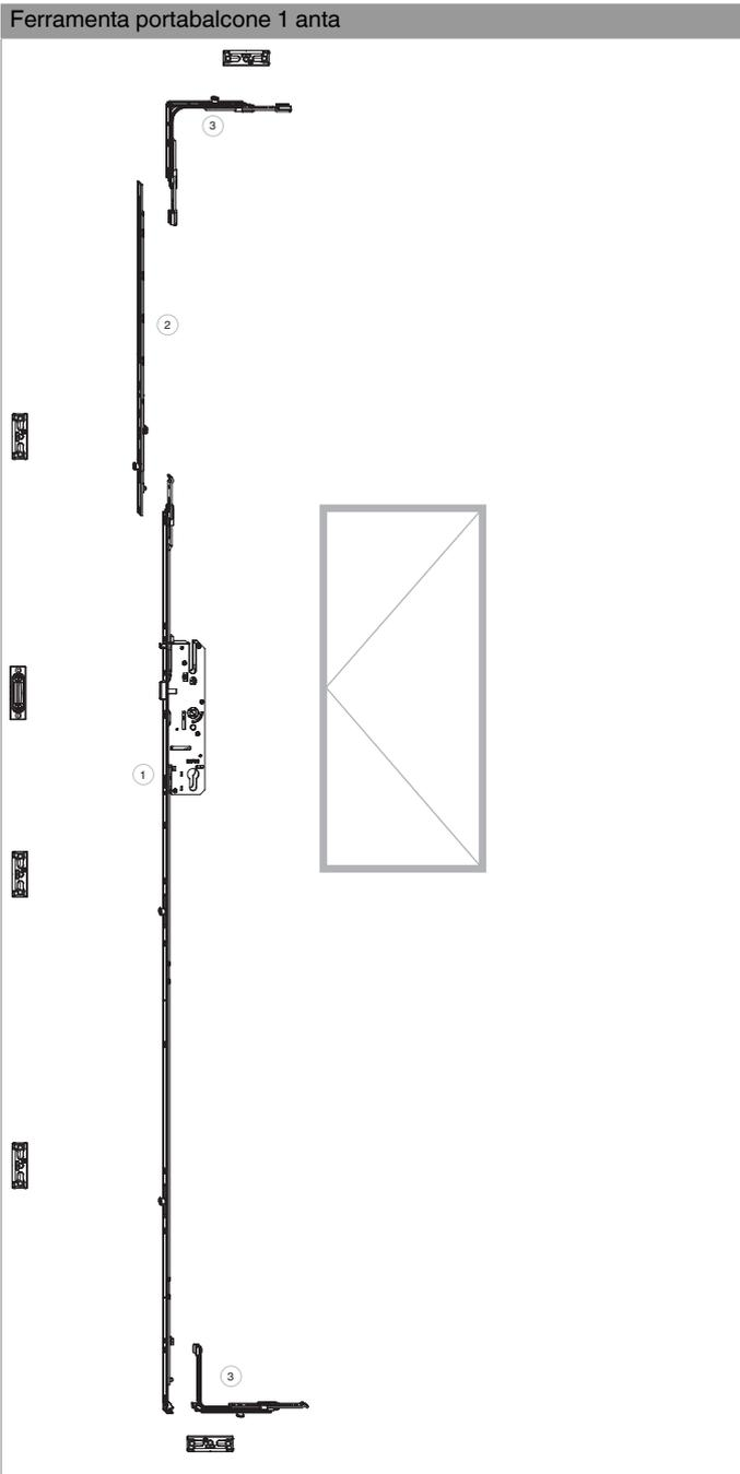
**203829 - Serratura per portafinestra con scrocco con 2
