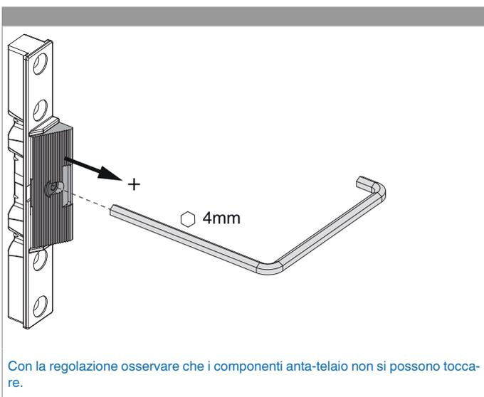
Con la regolazione osservare che i componenti anta-telaio non si possono toccare.
