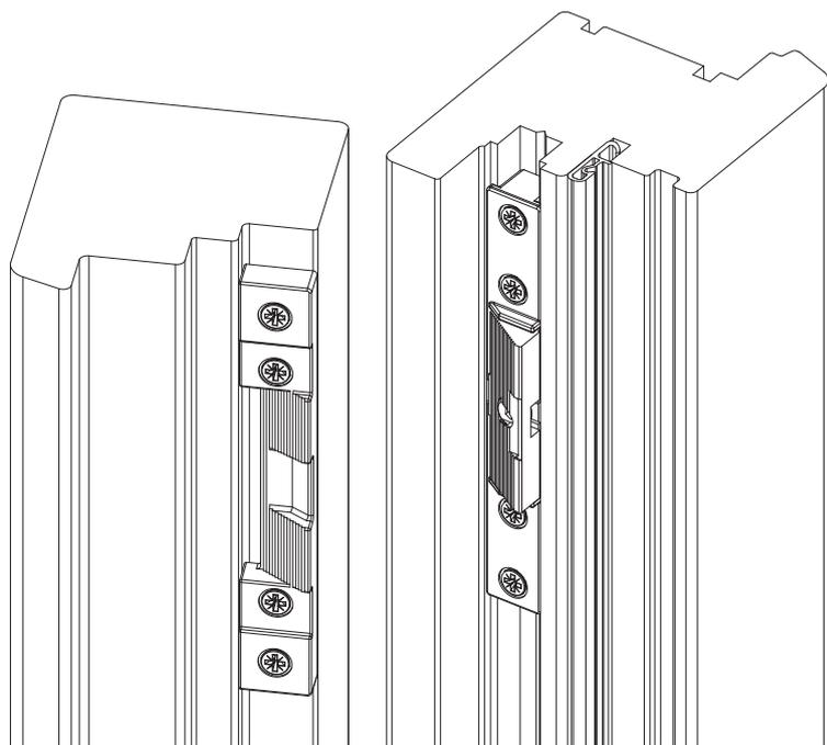
Applicare il componente per parte anta nella cava ferramenta, posizionarlo (centro componente per parte telaio) e avvitarlo.
