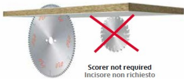
Working with spindle over the working plane Lavorazione con albero sopra il piano di lavoro
