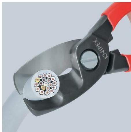
Taglio di finitura: Per facilitare il taglio, dopo aver tagliato la guaina del cavo sul profilo anteriore, vengono tagliati i conduttori sul profilo posteriore. Primo taglio in posizione anteriore, taglio di finitura in posizione posteriore, così si che si taglia volentieri.
