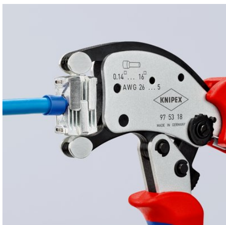
Straordinariamente flessibile: inserimento dei conduttori pressoché in tutte le posizioni entro la testa di crimpatura girevole Serraggio di terminali a bussola Twin fino a 2 x 6 mm 2 senza riposizionamento
