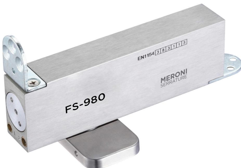
FS980 è un innovativo chiudiporta idraulico a pavimento per porte in legno e alluminio. Il sistema di chiusura è integrato all'interno della cerniera bassa e ha le stesse funzionalità dei comuni chiudiporta a pavimento. Ha il vantaggio di non essere invasivo a livello estetico e di non richiedere alcuna predisposizione: nessun buco nella pavimentazione o cassetta da cementare, con un notevole risparmio in termini di tempo e costo.
