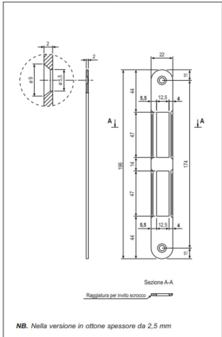
Applicazione con serratura frontale 18 mm
