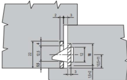
Applicazione con serratura frontale 22 mm
