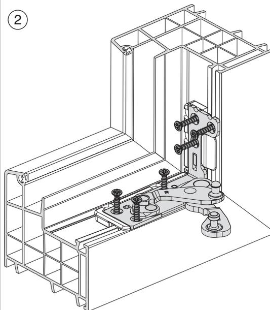
2. Infine fissare i supporti a forbice e le cerniere con una vite per PVC (almeno 4 x 30 mm, interamente filettata).
