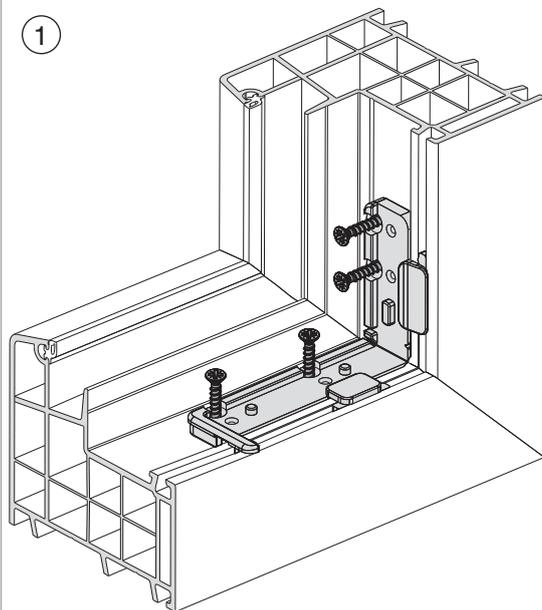
1. Fissare innanzitutto lo spessore (vedere scheda profilo) con una vite per PVC (almeno 4 x 30 mm, interamente filettata).
