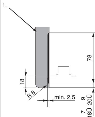
Angolo cerniera in appoggio con fissaggio sulla battuta
