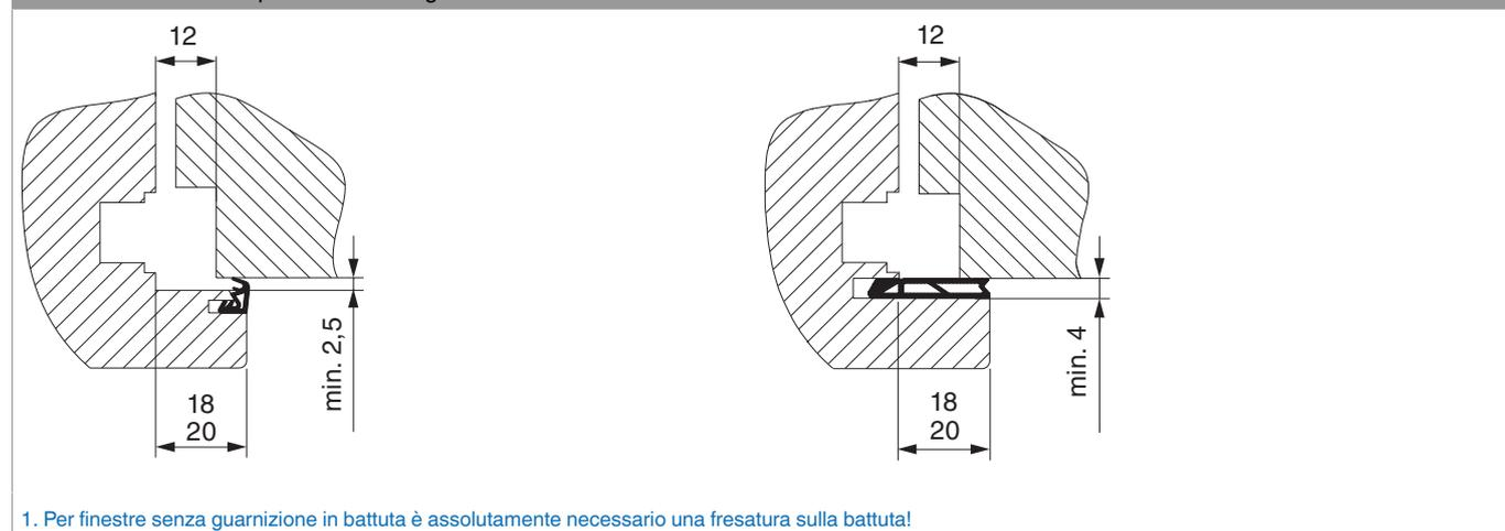
Fresatura sulla battuta per finestre senza guarnizione in battuta.
