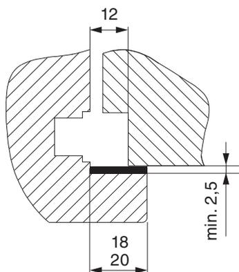
Fresatura sulla battuta per finestre senza guarnizione in battuta.
