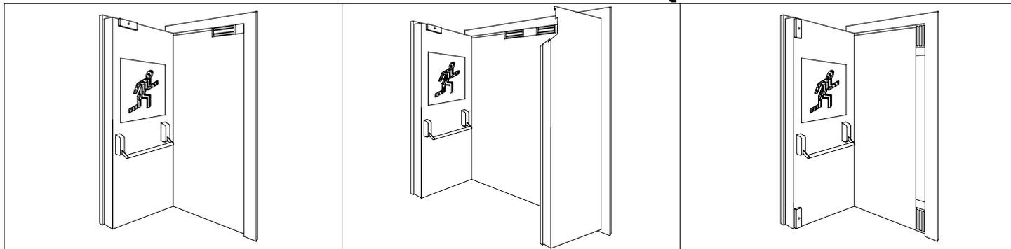
Esempio di applicazione dei mod. 13000-13100-13600-13700 su porta singola di Uscita di Sicurezza dotata di maniglione antipanico
